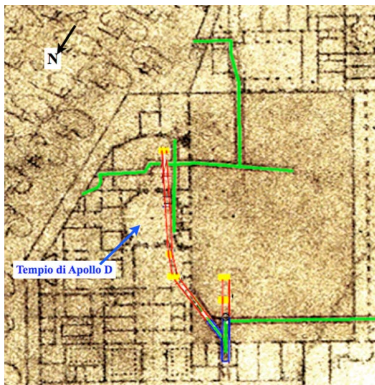
Fig. 25. La nuova pianta delle gallerie sovrapposta al disegno preparatorio di Piranesi (a Napoli) conferma il tracciato del cunicolo che passa sotto il Tempio di Apollo e indica che i due gruppi di gallerie facevano parte di un'unica rete di percorsi di servizio sotterranei (elaborato da Lui 2006).
