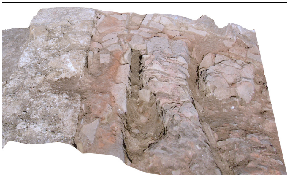
Fig. 8. DTM ed ortofoto nella visualizzazione in ArcScene.
